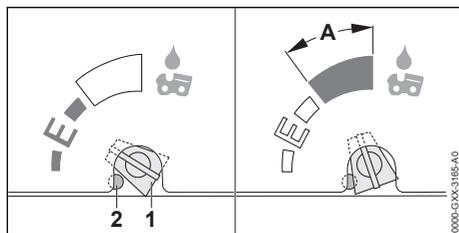
Когда регулировочный винт масляного насоса (1) находится в положении E (Ematic), расход масла является оптимальным для большинства применений.
